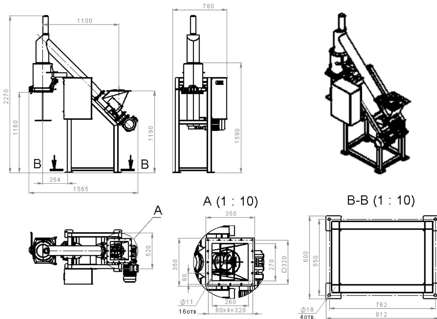
**Рис. 1. Габаритно-установочные размеры.**
