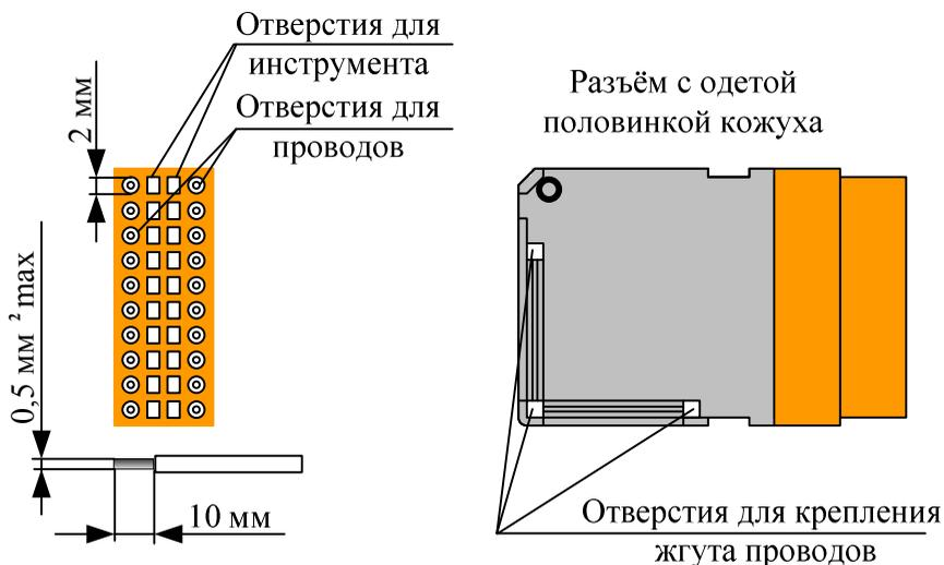
Рисунок Д.1 – Подключение проводов к разъемам Weidmuller
