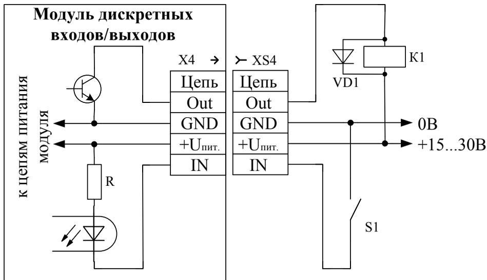
K1 - нагрузка (реле, магнитный пускатель, соленоид электропневмораспределителя и т.п.). Максимальная нагрузка 300мА/10Вт на канал;
