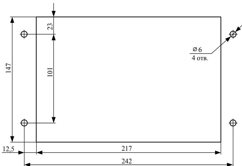
Рис. 2.1 Размеры вырезаемого окна для установки преобразователя ТВ-011
