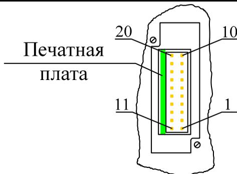
Рисунок Б.1 – Нумерация 20-и контактного разъема Weidmuller
