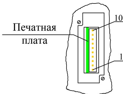
Рисунок Г.1 – Нумерация 10-и контактного разъема Weidmuller
